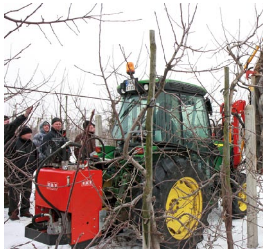
Fot. 4. Cięcie mechaniczne drzew wykonuje się z prędkością około 6 km/godz.
