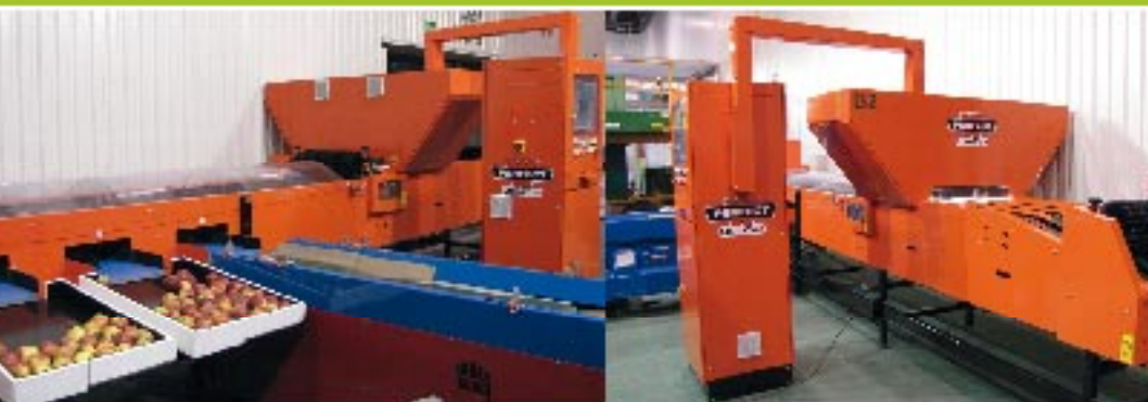
Linie do sortowania owoców Perfect UNI-CUP z rozładunkiem wodnym i wstępnym sortowaniem BURG
